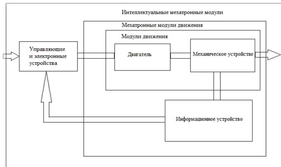
Рисунок 1 – Структурная схема мехатронного модуля
