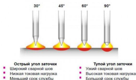
Рисунок 2 – Рекомендации по заточке электрода
