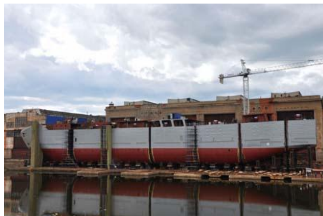
Рисунок 16 – Сборка корпуса из блоков на понуре наливного бассейна
