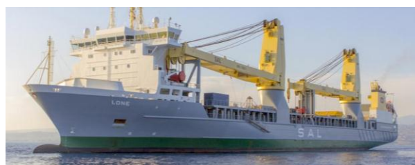
Рисунок 8 – Носовое расположение ходовой рубки
