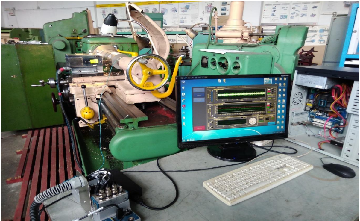
Рисунок 1 – Структура токарного станка для исследования работоспособности металлорежущего инструмента
