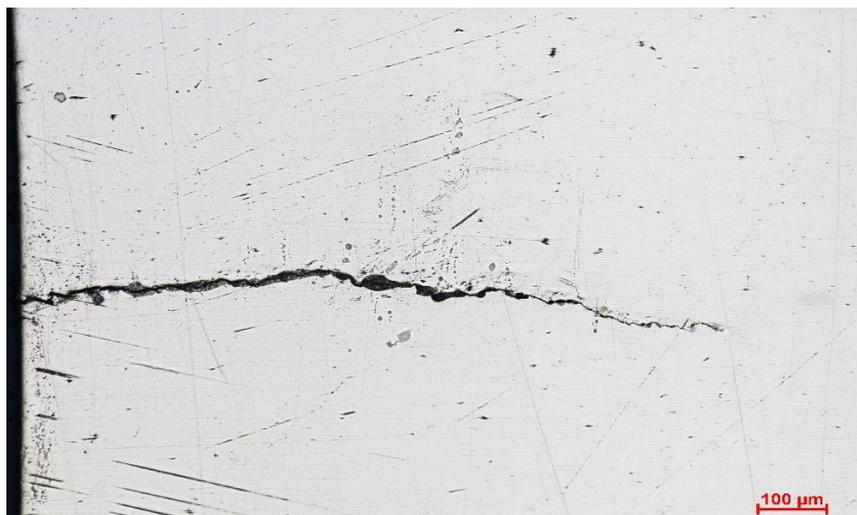
Рисунок 4 - Трещина на образце стали, полученной 3D печатью СЛС методом после усталостных испытаний образца 01
