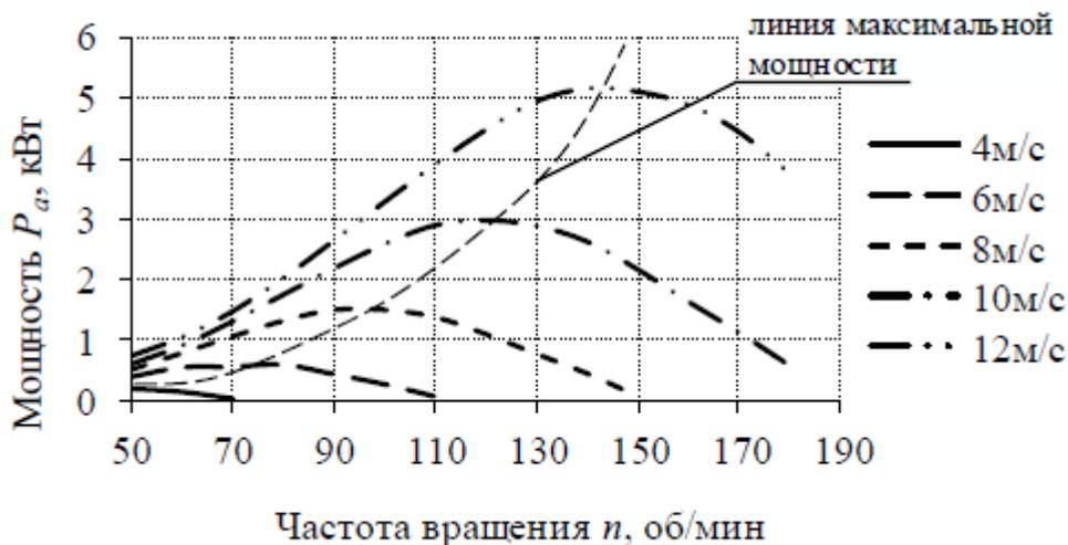
Рис. 1 – Зависимость генерируемой мощности от частоты вращения ветроколеса для разных скоростей ветра.
