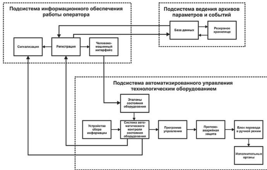
Рисунок 1 - Функциональная схема системы управления роботизированным процессом
