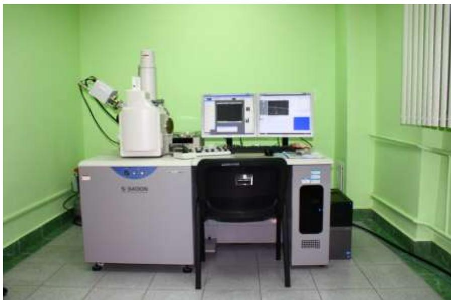
Рисунок 6 – Электронный сканирующий микроскоп Hitachi S-3400N
