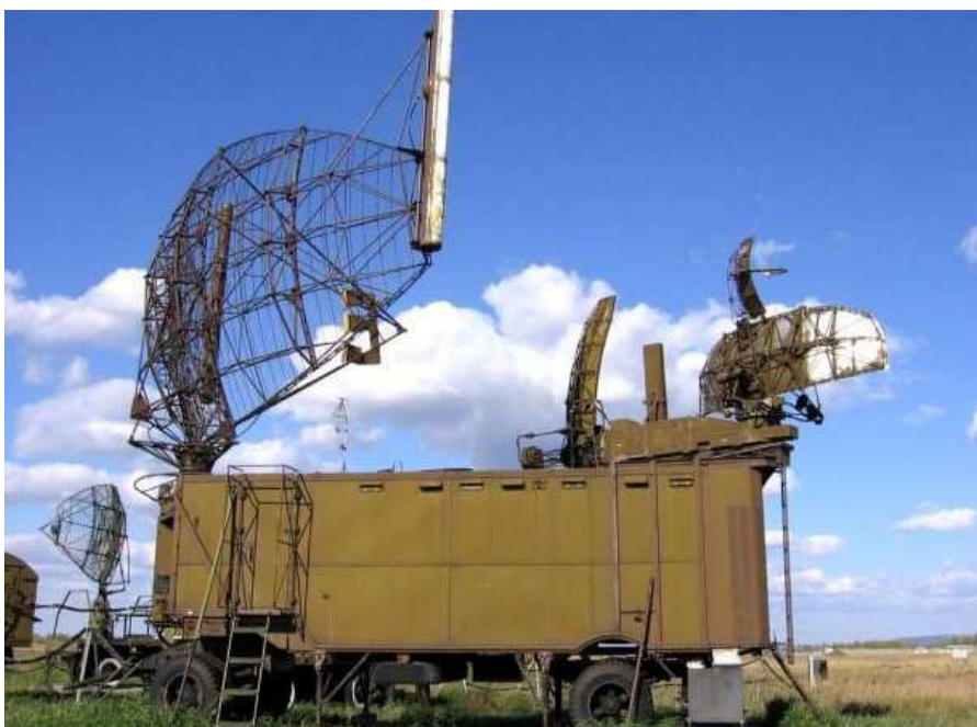
Рис. 5 Посадочная радиолокационная станция ПРЛС-6М2
