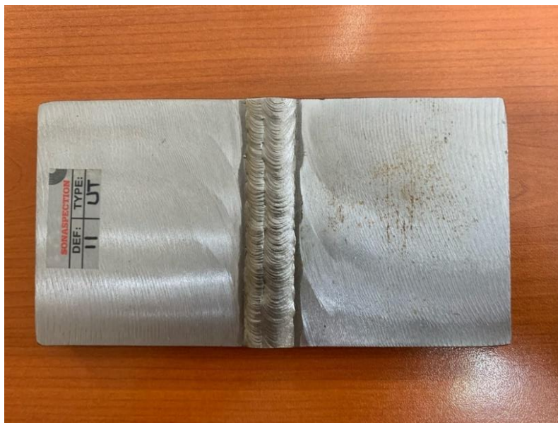
Рисунок 2 – Непровар корня сварного шва
