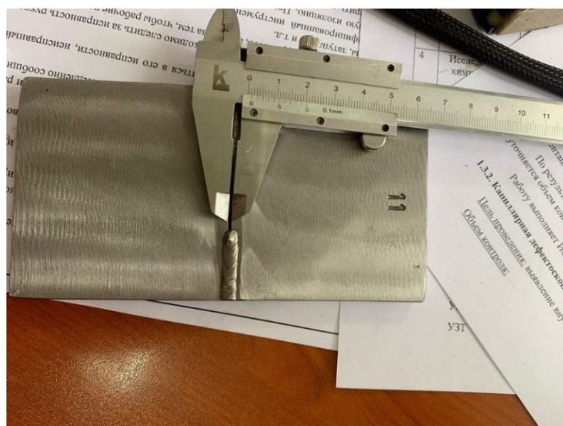
Рисунок 3 – Непровар корня сварного шва
