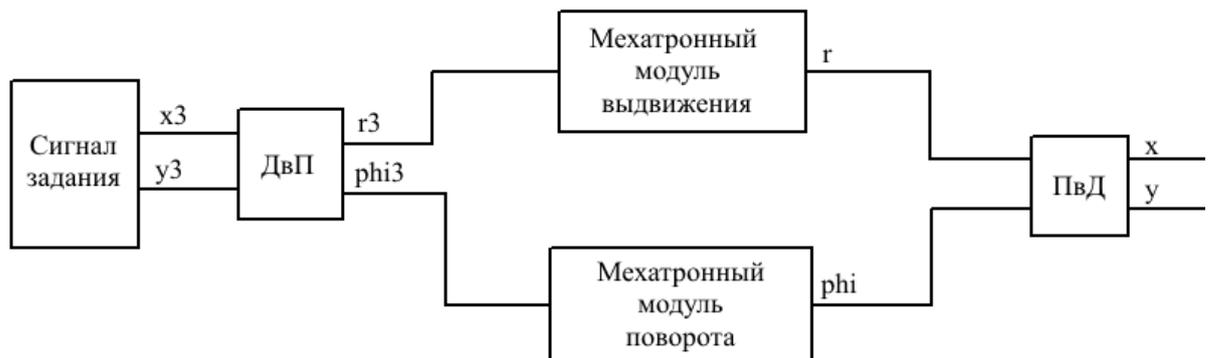
Рисунок 2 – Структурная модель манипуляционной системы
