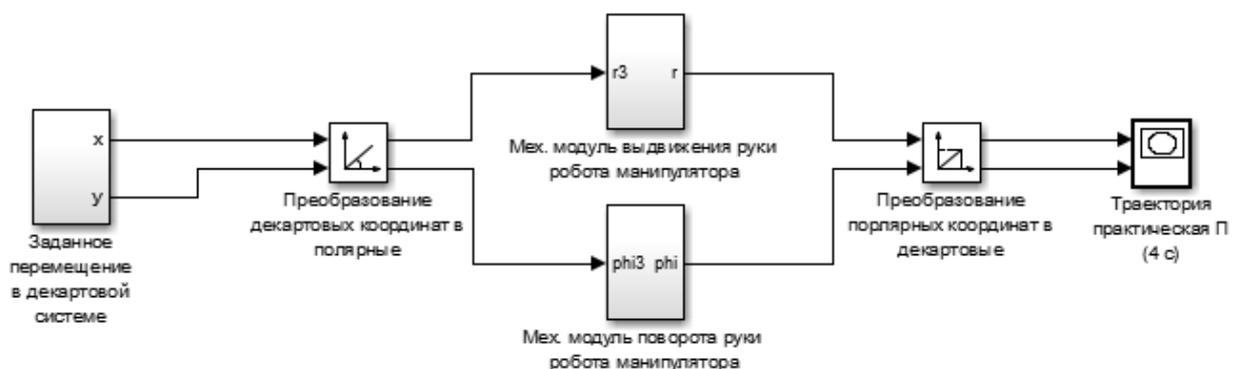
Рисунок 3 – Модель манипуляционной системы в среде Simulink
