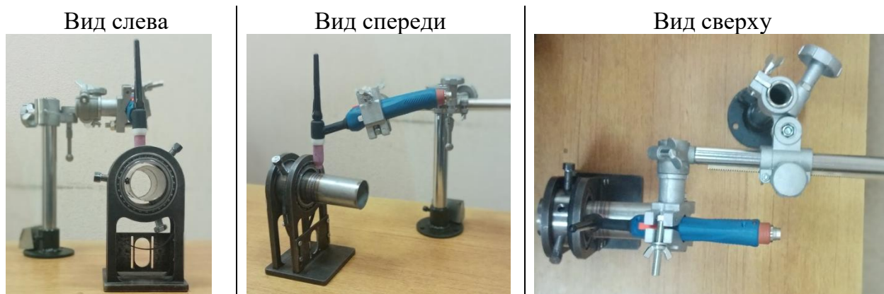
Рисунок 5 – Схема комплектации роботизированной системы для сварки криволинейных тонкостенных трубопроводов
