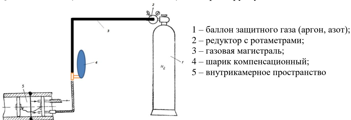
Рисунок 8 – Общая схема компоновки системы поддува
