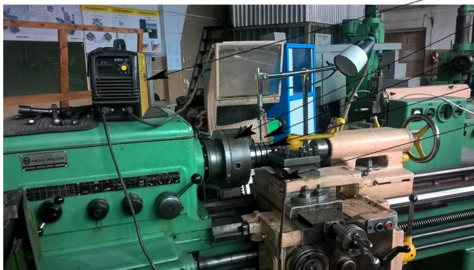
1 –Блок управления магнитным полем, 2 – Токарно-винторезный станок 16К20, 3 – Изолированный графит на вспомогательном держателе с токоподводящим элементом, 4 – Изолированная заготовка, 5 – Изолированный резец ВК8 с токоподводящим элементом
