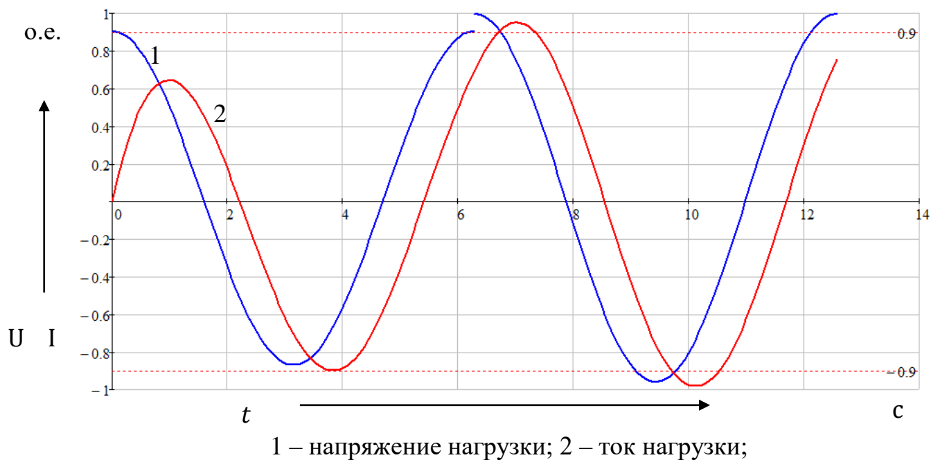
Рисунок 4.3 – Зависимости тока и напряжения нагрузки от времени работы при режиме из закоротки в плавную вольтодобавку
