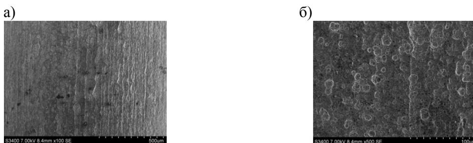
Рисунок 12 – Поверхность сварочной проволоки
