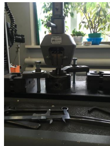
Рисунок 4 – Схема проведения механических испытаний на вырывание
