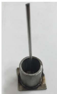
Рисунок 2 – Внешний вид стальной формы для заливки алюминия
