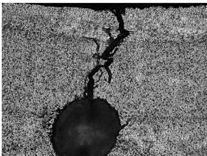
Рисунок 3 – Микроструктура АМг2 при E = 86 , увеличение \times 400
