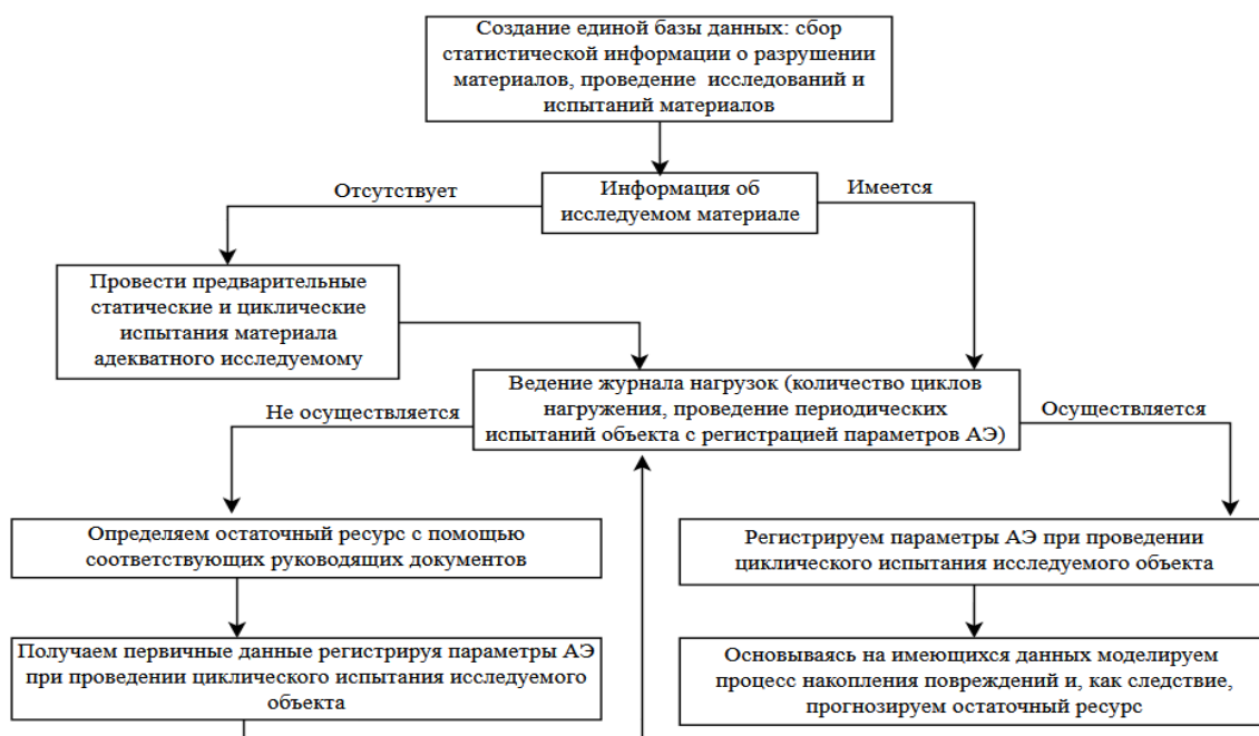
Рисунок 7 – Алгоритм определения остаточного ресурса при регистрации параметров АЭ
