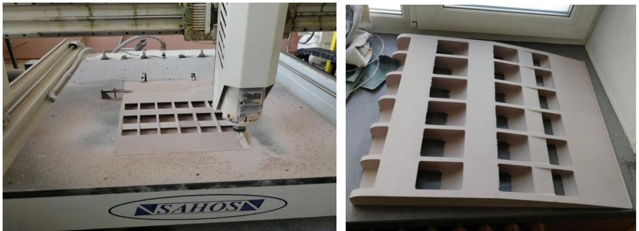
Рисунок 6- Изготовление модели движителя
