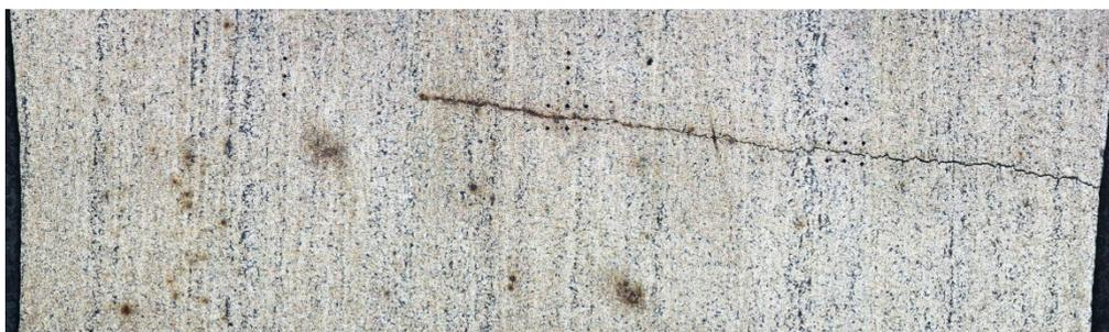
Рисунок 1 – Расположение трещины на образце №06, x100
