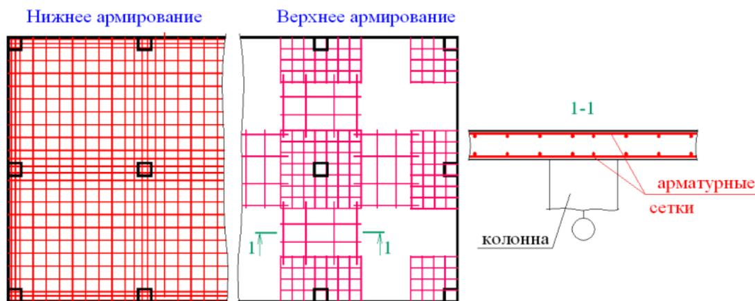
Рисунок 3.8 - Схема двойного армирования монолитной безбалочной плиты
