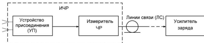
Рисунок 3 – Структурная схема ИЧР
