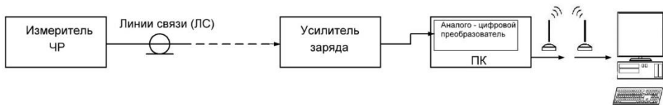
Рисунок 2 – Структурная схема системы мониторинга изоляционных конструкций
