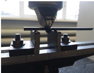
Рисунок 6 - Методика и оснастка для проведения статического растяжения (а) и изгиба (б)
