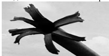
Рисунок 2 - Пример раздутия Р18 при РСТ
