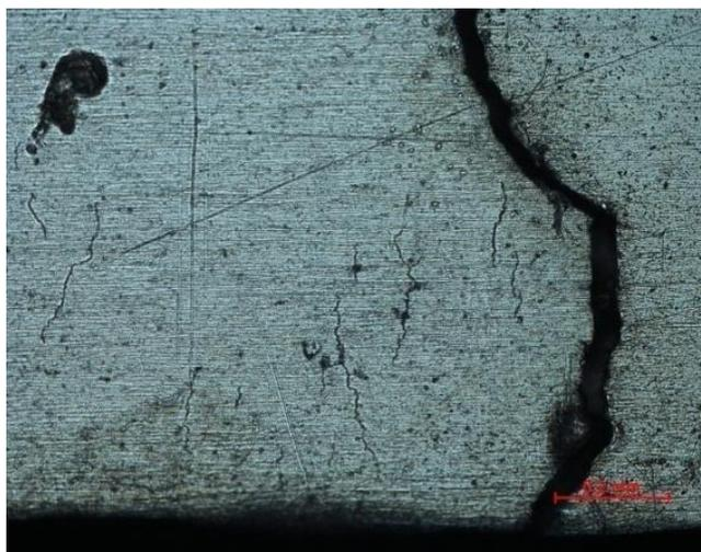
Рисунок 7 - Фрагмент магистральной трещины образца № 14,  $\sigma=250$  МПа,  $\Delta N=14705$
