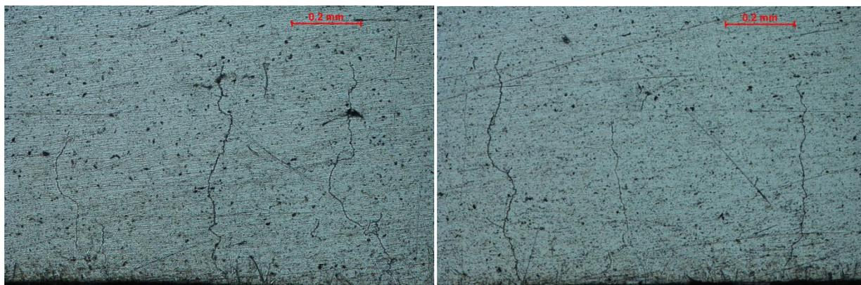
Рисунок 4 - Усталостные микротрещины образца, испытанного при  $\sigma = 250$  МПа
