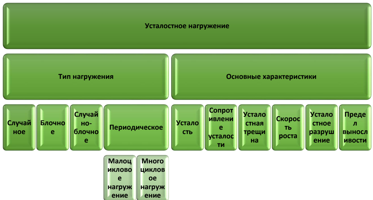
Рисунок 1 - Виды усталостного нагружения и характеристики
