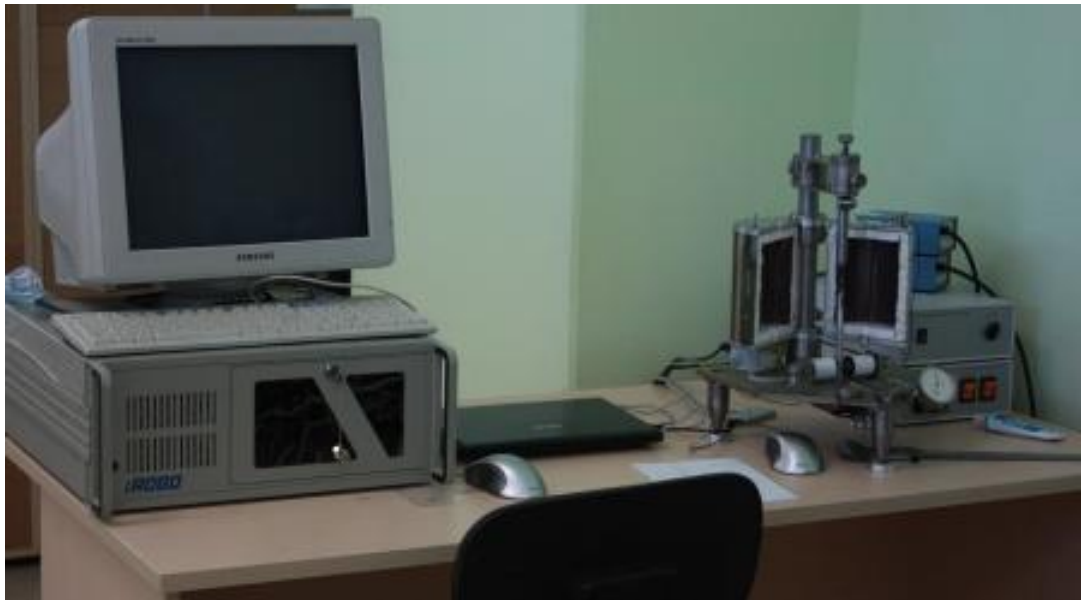
Рисунок 9 - Лабораторная установка для определения усталостных характеристик легких сплавов
