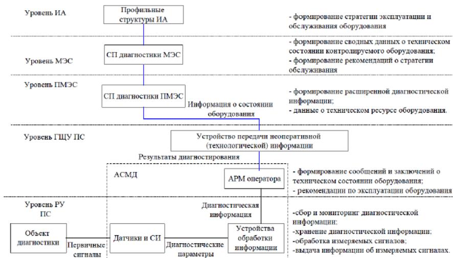
Рисунок 7 – Схема передачи диагностической информации по уровням управления
