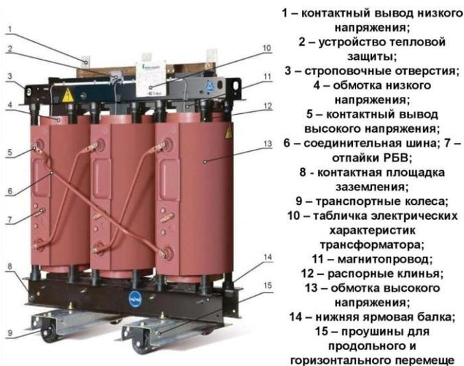
Рисунок 2 – Конструкция сухого трансформатора
