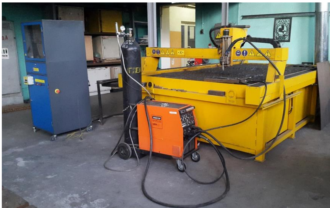
Рисунок 1 – Адаптированный 3D станок для дуговой наплавки
