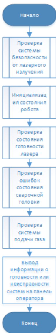
Рисунок 5 - Алгоритм проверки систем на состояние готовности
