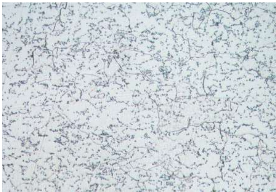
Рисунок 5 – Структура стали марки Ст20 при увеличении \times 400
