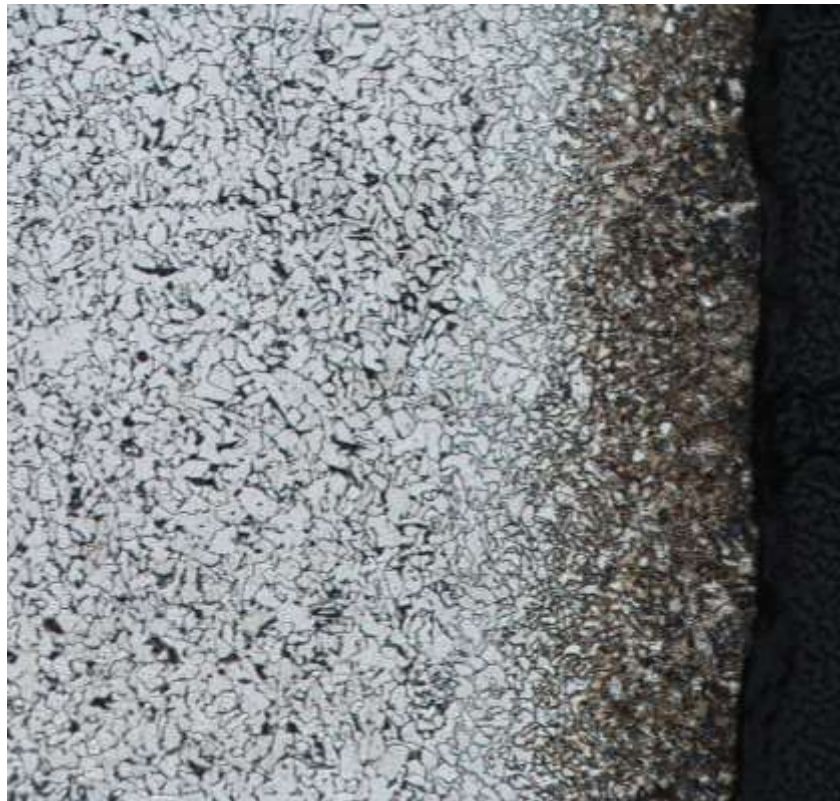
Рисунок 8 – Структура стали Ст3пс после лазерного воздействия при увеличении x400
