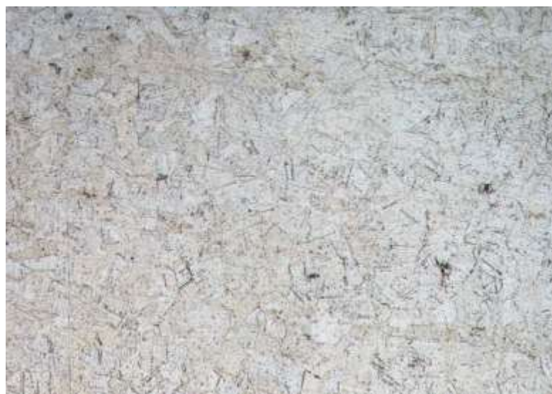
Рисунок 9 – Структура стали 12X18H10T при увеличении x400
