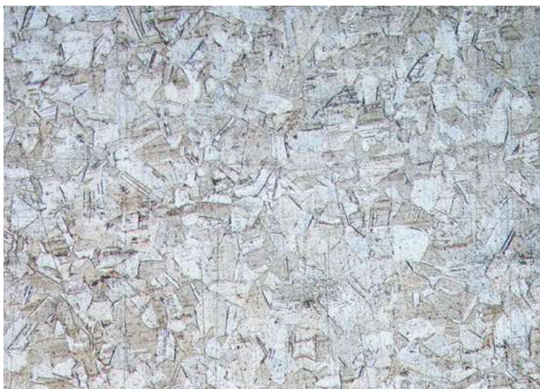
Рисунок 1 - Структура стали 12X17 при увеличении x400
