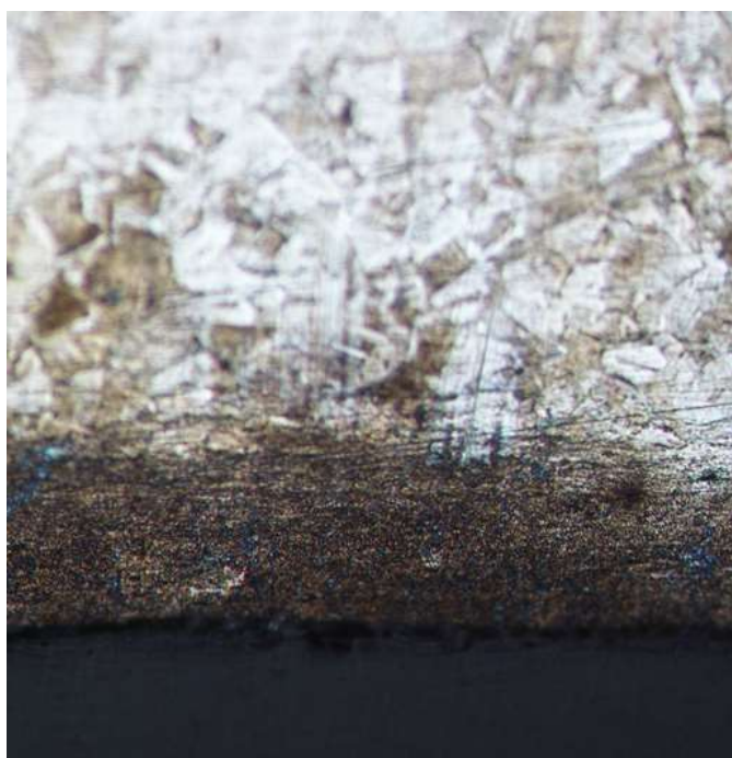
Рисунок 4 – Структура стали 12Х17 после лазерного воздействия при увеличении \times 400
