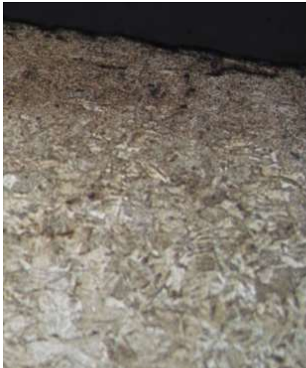
Рисунок 10 – Структура стали 12X18H10T после лазерного воздействия при увеличении x400
