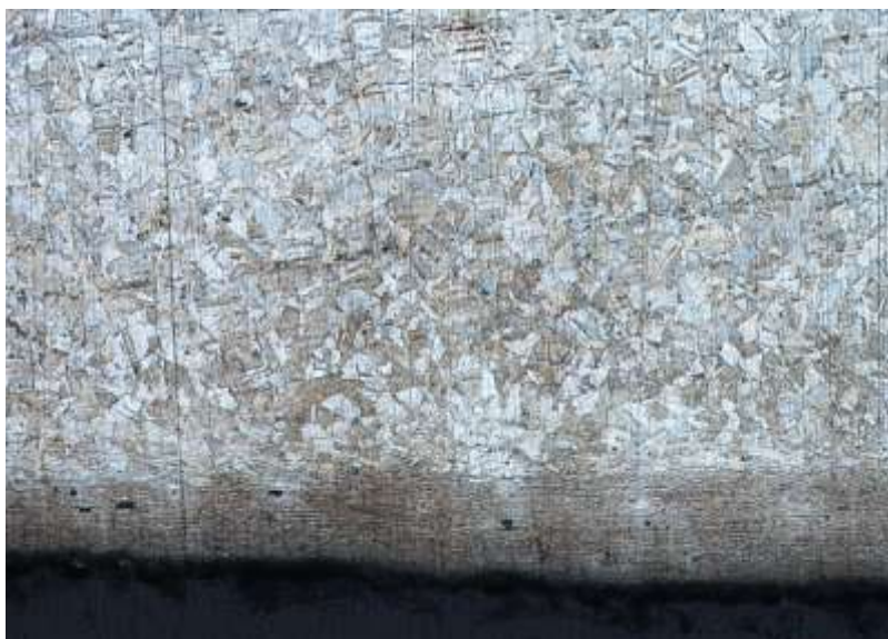
Рисунок 3 – Структура стали 12Х17 после лазерного воздействия при увеличении \times 200
