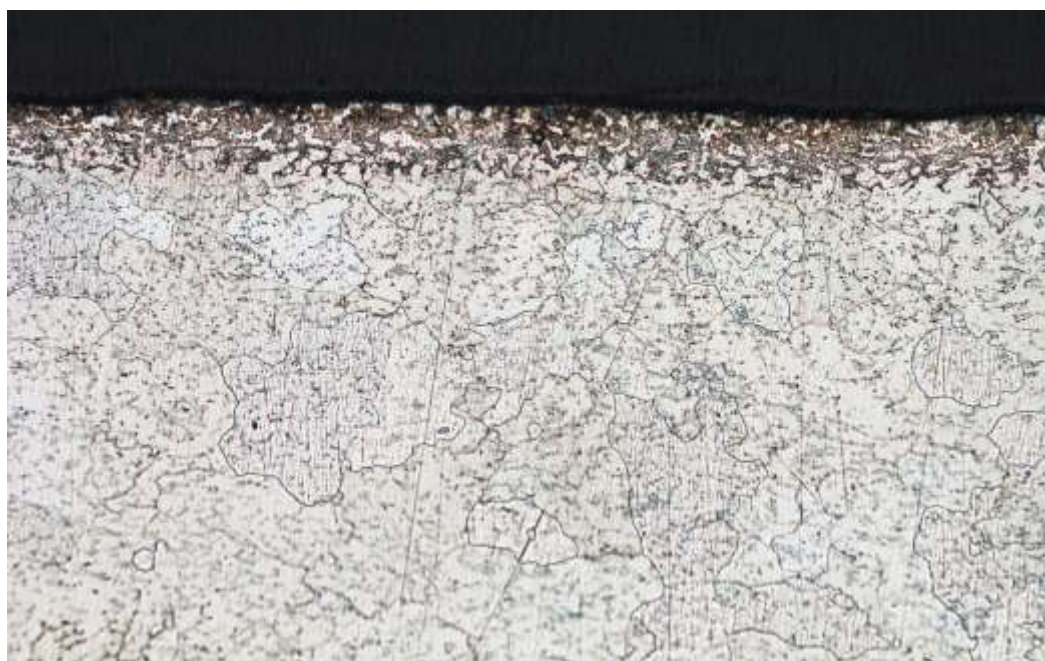
Рисунок 6 – Структура стали Ст20 после лазерного воздействия при увеличении \times 200
