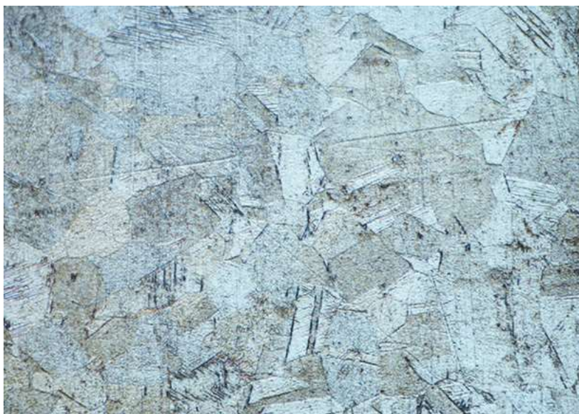
Рисунок 2 - Структура стали 12X17 при увеличении x1000
