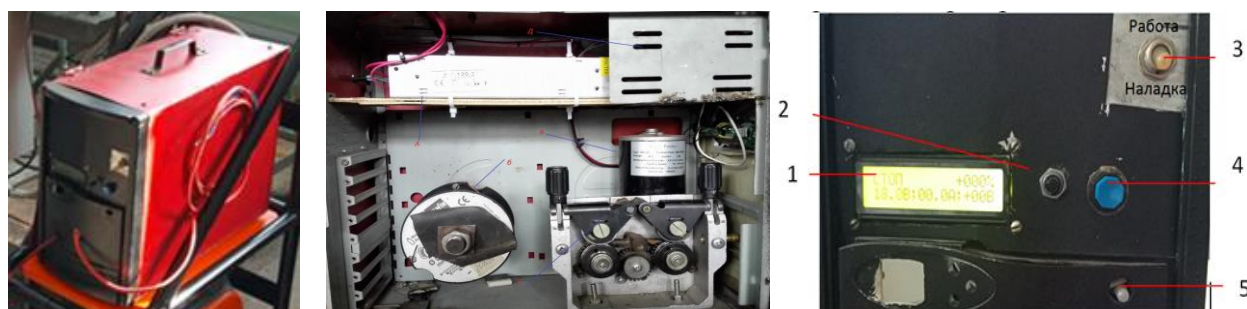
Рисунок 2 - Общий вид, состав и интерфейс устройства подачи проволоки
