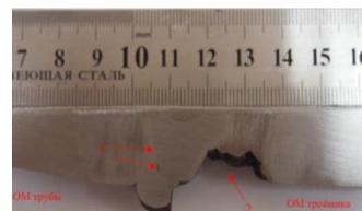
Рисунок 9 - Дефекты в корне шва образца П-479-5
