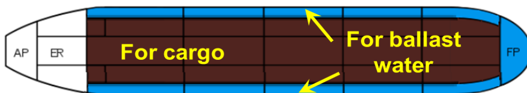
Рисунок 1 – Схема двухкорпусного танкера
