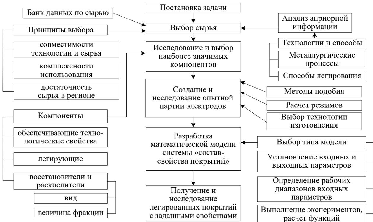
Рисунок 1 - Блок-схема создания сварочно-наплавочных электродов
