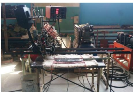
Рисунок 1 - Экспериментальный стенд для сварки с предварительным и сопутствующим подогревом
