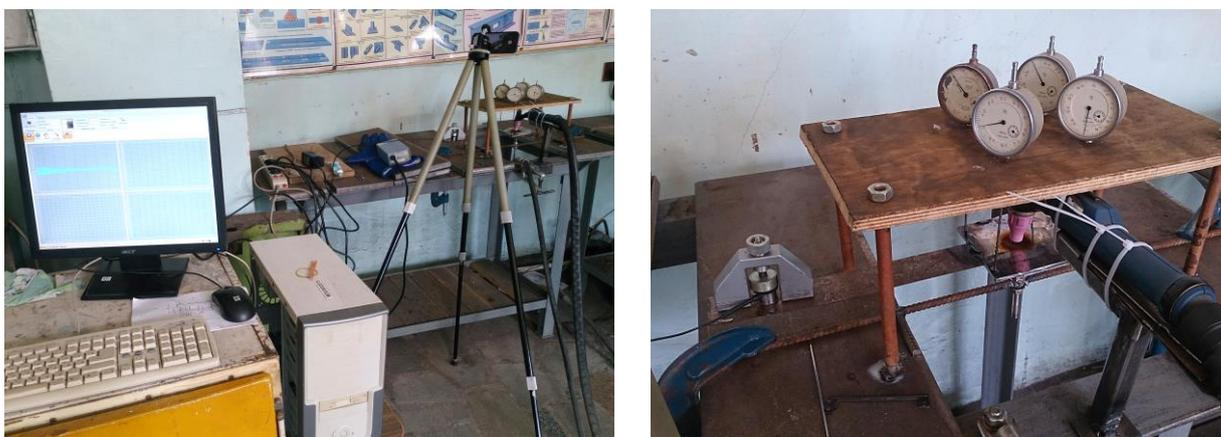
Рисунок 3 - Стенд для исследования деформаций и определения фазовых превращений с применением АЭ
