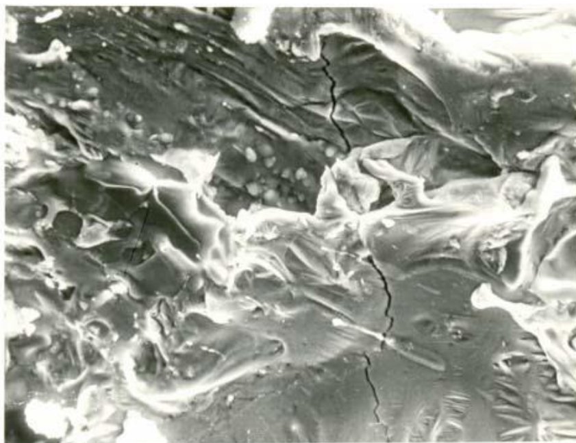
Рисунок 5 - Наличие трещин на поверхности реза алюминиевого сплава при лазерной резке
