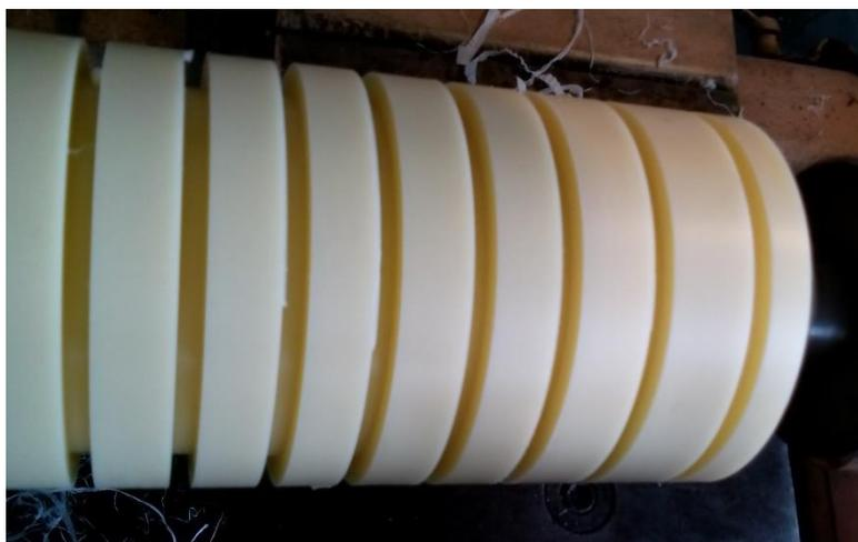
Рисунок 3 – Заготовка из капролона
