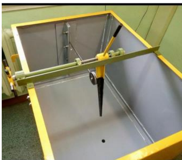
Рисунок 2 – Чаша бассейна экспериментальной установки
