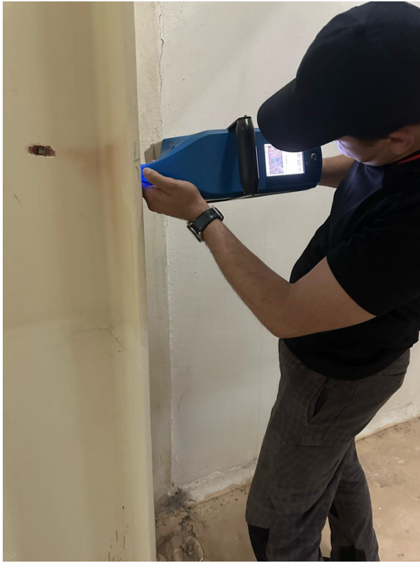
Рисунок 5 и рисунок 6– Проведение контроля по определению химического состава элементов
