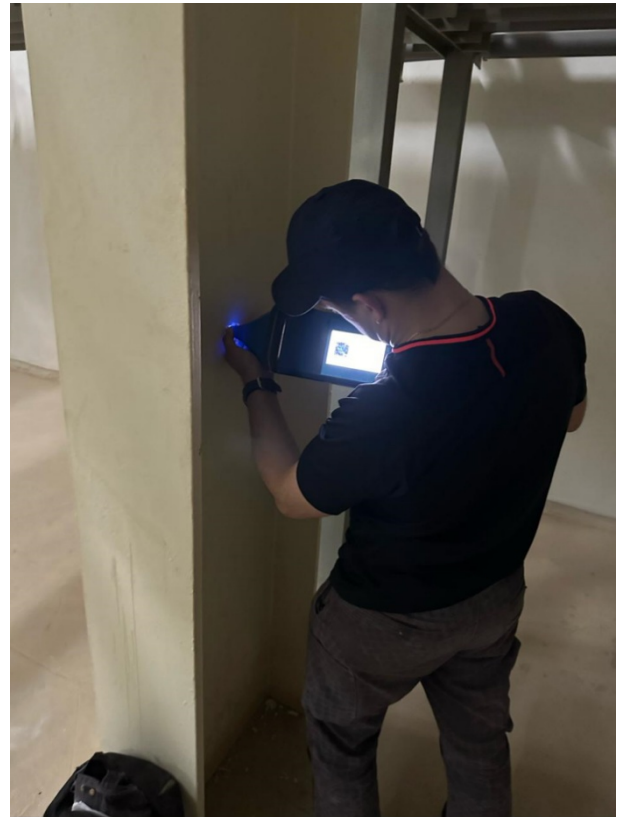
Рисунок 5 и рисунок 6– Проведение контроля по определению химического состава элементов
