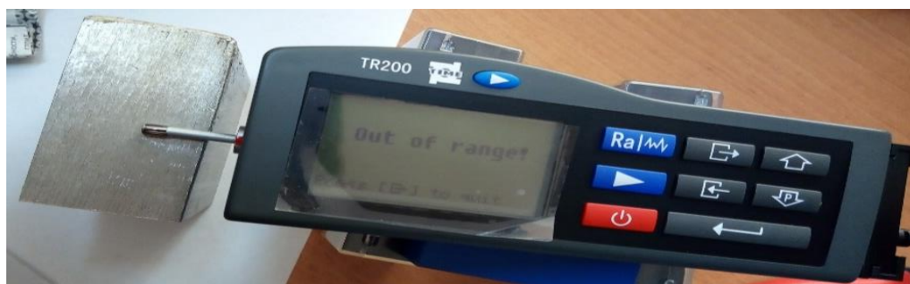
Рисунок.3. Пример измерения шероховатости на образце, выполненном из алюминиевого сплава марки АК4
