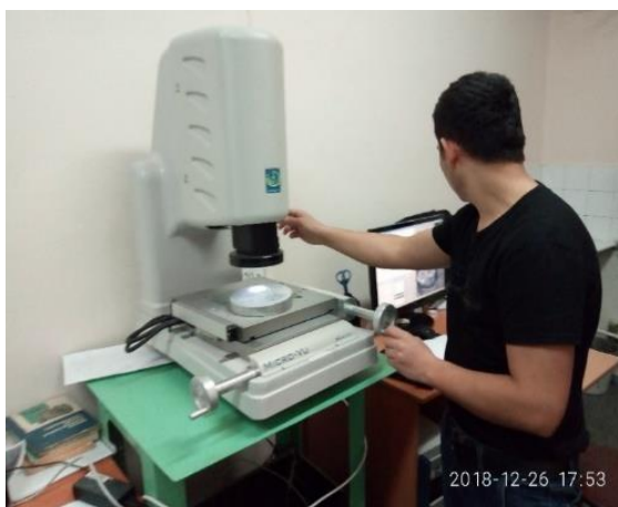
Рисунок.4. Процесс измерения дефектов (предположительно – приваренная стружка) с помощью видео-измерительной машины модели Micro. Vu Sol 165 на поверхности образца алюминиевого сплава марки В95 [2]
