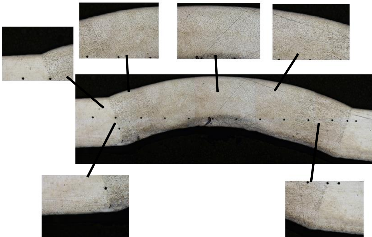
Рисунок 9 – Микроструктура поперечного сечения сварного образца 2
