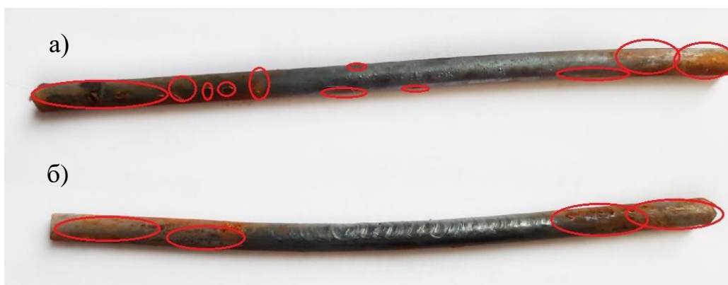
Рисунок 7 – Образование ржавчины на образцах спустя 288 часов после погружения в агрессивную среду: а – обработанные лазерным лучом без проплавления поверхности; б – обработанные лазерным лучом с проплавлением поверхности
