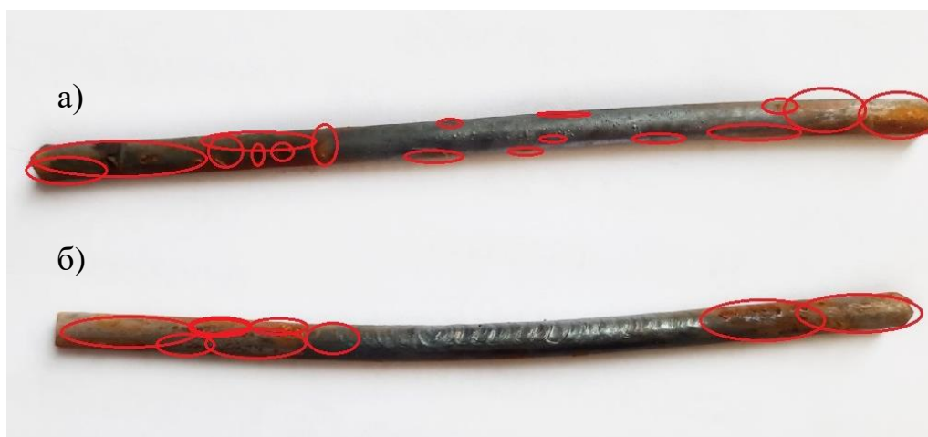
Рисунок 8 – Образование ржавчины на образцах спустя 360 часов после погружения в агрессивную среду: а – обработанные лазерным лучом без проплавления поверхности; б – обработанные лазерным лучом с проплавлением поверхности
