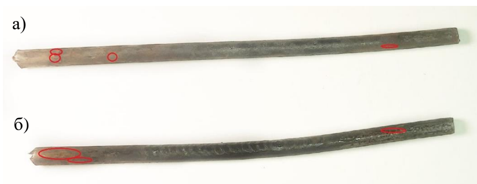
Рисунок 5 – Образование ржавчины на образцах спустя 144 часа после погружения в агрессивную среду: а – обработанные лазерным лучом без проплавления поверхности; б – обработанные лазерным лучом с проплавлением поверхности
