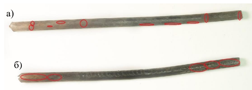
Рисунок 6 – Образование ржавчины на образцах спустя 216 часов после погружения в агрессивную среду: а – обработанные лазерным лучом без проплавления поверхности; б – обработанные лазерным лучом с проплавлением поверхности
