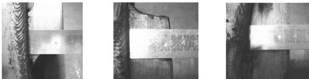
Рисунок 3 – Размеры выступающей части гильзы
