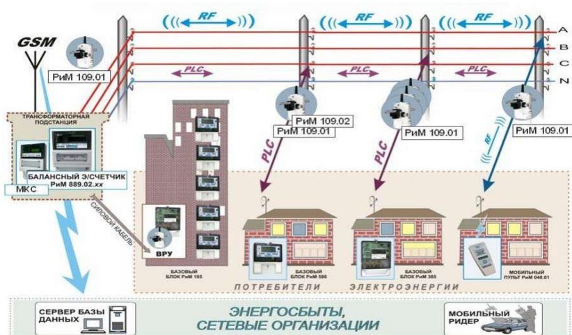
Рисунок 4 - Структурная схема системы на базе «RiM»
