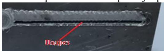
Рисунок 10 - Подрез (дефект в виде канавки)
