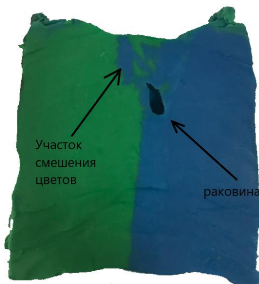
Рисунок 5 – Поперечный разрез двух соединенных пластилиновых полос (скорость вращения инструмента 710 об/мин; угол наклона 3^0 ; скорость сварки 210 мм/мин)
