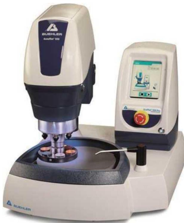
Рисунок 2– Шлифовально-полировальный станок для подготовки образцов Buehler EcoMet 250 Pro
