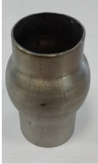
Рисунок 7-Деталь «патрубок» после операции раздачи
