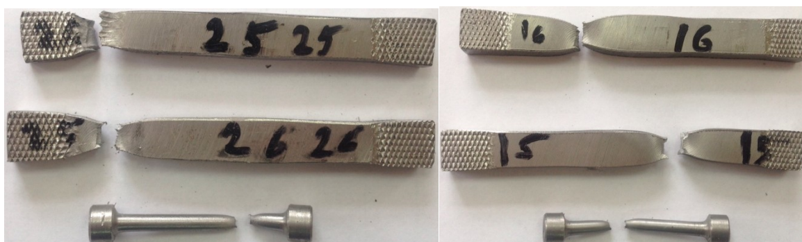
Рисунок 12 – Образцы после испытаний на статическое растяжение
