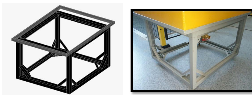
Рисунок 1.5 - Подставка под установку (а) - 3D вид; (б) – фотография подставки под установку
