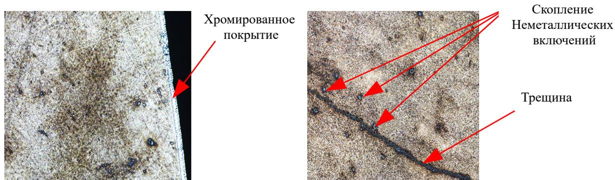
Рисунок 2 — Микроструктура пуансона из стали 7ХГ2ВМФ
