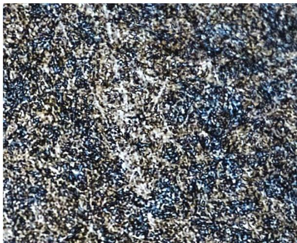
Рисунок 4 — Распределение карбидной сетки
