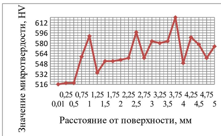
Рисунок 5 — Распределение микротвердости в зависимости от расстояния от поверхности
